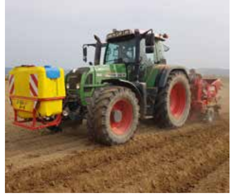
LF 600 M1 mit Kartoffellegger zum gleichzeitigen Ausbringen eines Startdüngers oder eines Kartoffelbeizmittels
