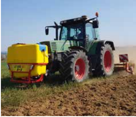
LF 600 M1 kombiniert mit einer Kreiselegge oder Fräse zum Ausbringen von bodenstärkenden Mikroorganismen im biologischen Landbau
