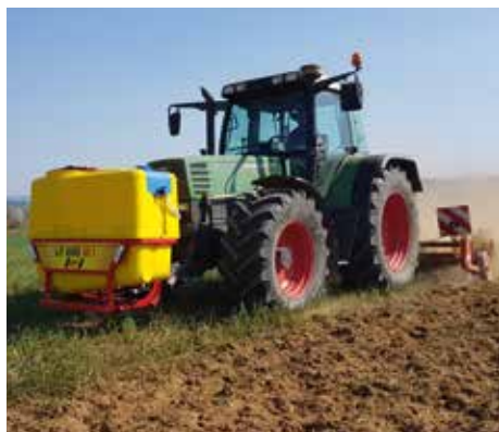
LF 600 M1 z broną wirnikową lub formiarką do rozproszania mikroorganizmów wzmacniających glebę w uprawach ekologicznych
