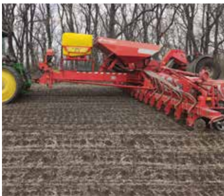
LF 600 M1 z siewnikiem punktowym do rozprowadzania nawozu płynnego podczas siewu
