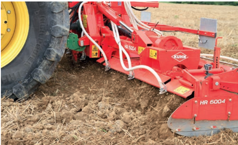
Ausbringung von zwei unterschiedlichen Saatgütern: großes Saatgut zur tieferen Einarbeitung vor den Zinken ...
