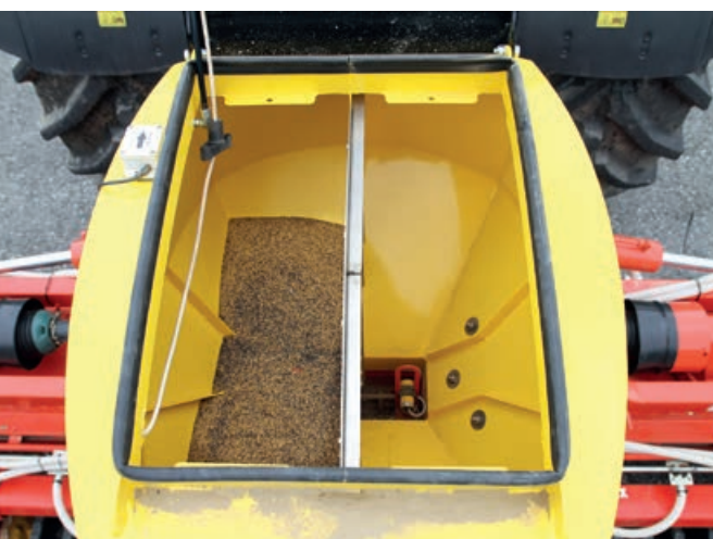
Korrosionsbeständiger 300 l Stahlbehälter mit mittiger Teilung und zwei serienmäßigen Füllstandssensoren.
