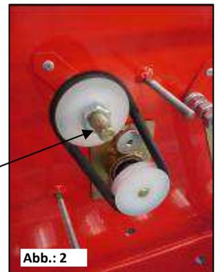
3. Befestigen Sie den gelieferten Anzeiger auf der Rührwerkswelle (M10 Gewinde) (mit 2 Stk.17er Schlüsseln).
